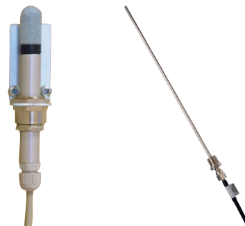
Czujnik wilgotności i regulator 2, wraz dają one możliwości kontrolowania cieczy punktu rosy. Czujnik jest w standardzie, a sterownik jest opcjonalne
